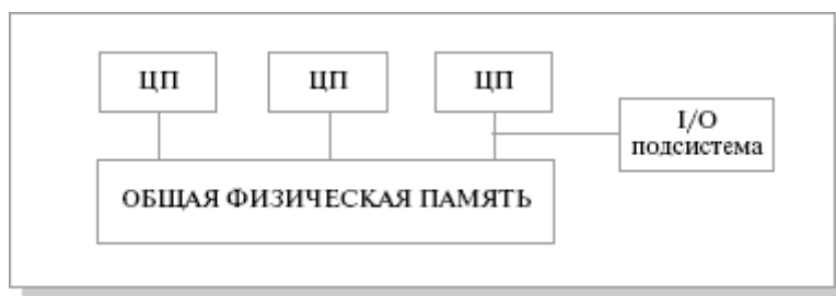
Рис. 3.1. Схематический вид SMP-архитектуры
