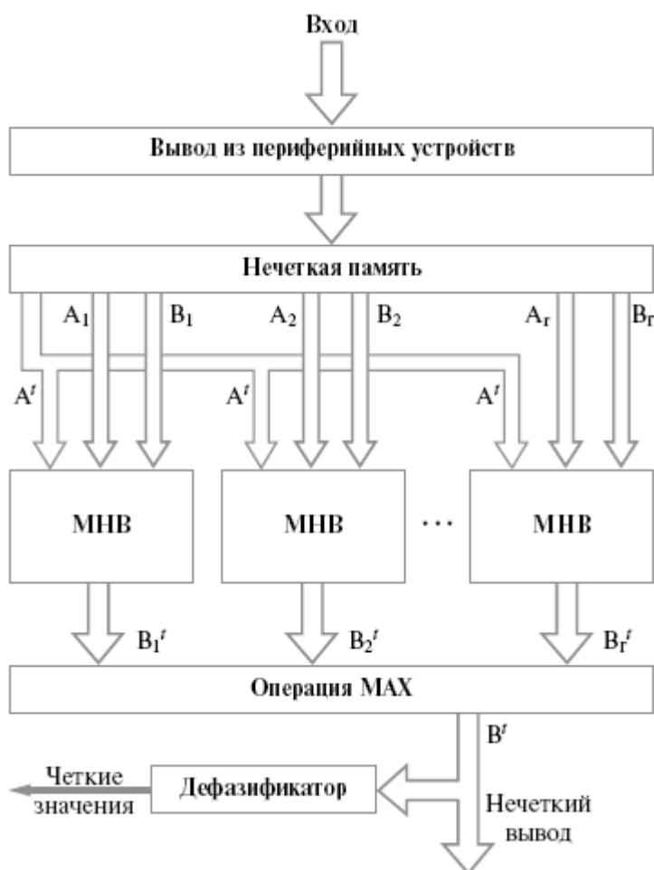
Рис. 8.5. Архитектура нечеткого компьютера (МНВ-механизм нечеткого ввода)
